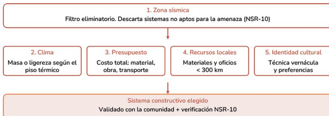
Figura 32. Flujo de selección del sistema constructivo: la zona sísmica filtra primero; clima, presupuesto, recursos e identidad afinan la decisión.
