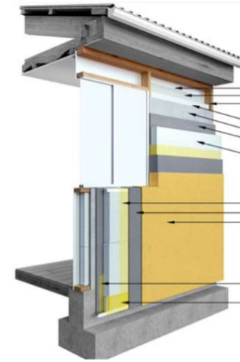
Aislación térmica exterior en tabique de madera EIFS o listoneado de madera exterior
