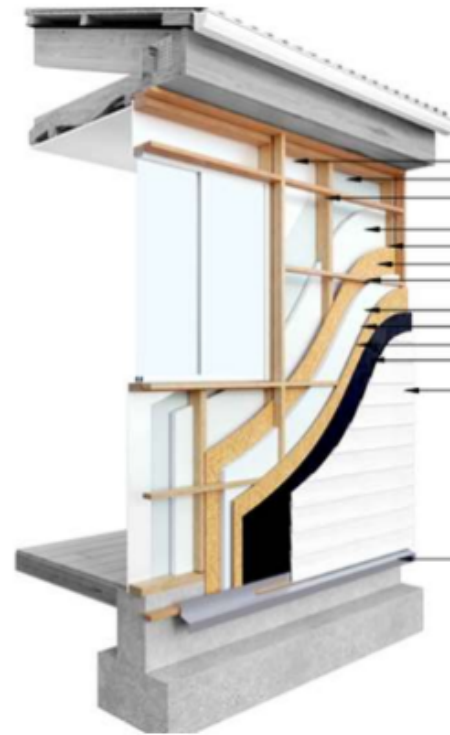
Aislación térmica exterior en tabique de madera EIFS o listoneado de madera exterior
