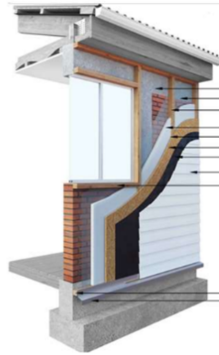
Aislación térmica exterior en muro sólido EIFS o listoneado de madera exterior
