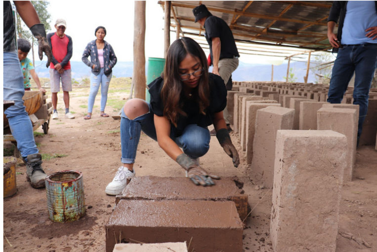
Figura 43. Visita a productor de adobe y experimentación en la fabricación de un bloque de adobe.
