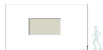
Fachada con 5% abertura respecto superficie de piso
