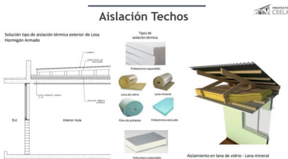
Figura 54. Aislación techos, elaboración equipo CEELA.
